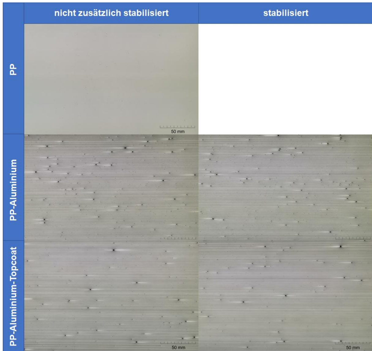
Abbildung 3: Optische Erscheinung der unterschiedlichen Folienrezepturen im Ausgangszustand (Durchlichtaufnahmen am Leuchttisch)
