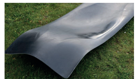
Infusionierte Liege aus CFK
